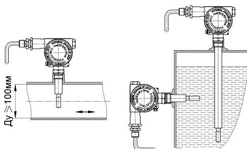
Рисунок 5.6 – Варианты монтажа плотномеров
