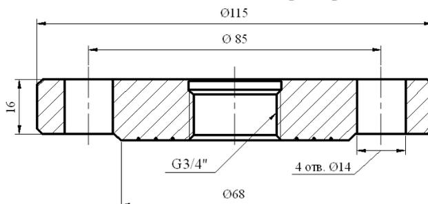
Рисунок 5.5 - фланец переходной Ду25 / G3/4", Ру = 4МПа
